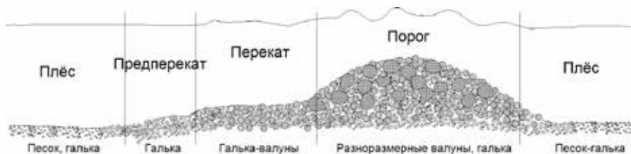
Рис. 15. Схема последовательного укрупнения фракций грунта и возрастания скоростей течения на разных типах биотопов беломорских и баренцевоморских рек
